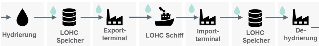
Abbildung 4-6: Prozesskette für den Schiffftransport von LOHC
