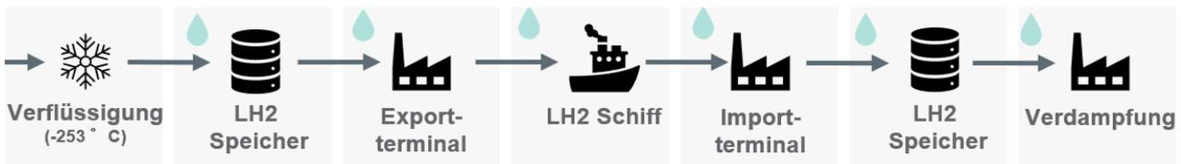
Abbildung 4-4: Prozesskette für den Schifftransport von Flüssigwasserstoff
