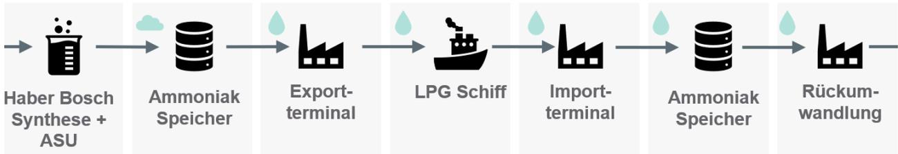
Abbildung 4-5: Prozesskette für den Schifftransport von Ammoniak
